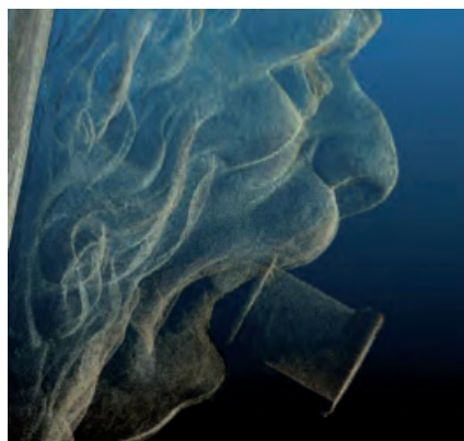
Figure 9. (à gauche) Nuages de points réalisés avec des photographies en mode macro ; (à droite) Modèle de maillage texturé avec la couleur extraite du nuage de points photogrammétriques.
