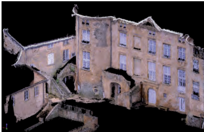
Figure 7. Modèles 3D des façades du château de Theizé réalisés par photogrammétrie.
